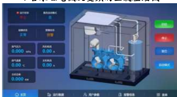
空氣壓縮機的操作介面
